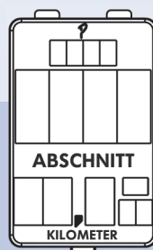
Stationierungstafel Grundplatte 90 mm x 140 mm 1 x 4-teilig, 15 mm Feld „Abschnitt“, „Kilometer“
