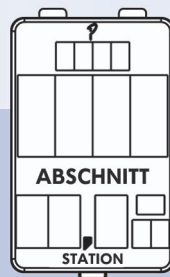
Stationierungstafel Grundplatte 90 mm x 140 mm 1 x 4-teilig, 15 mm Feld „Abschnitt“, „Station“
